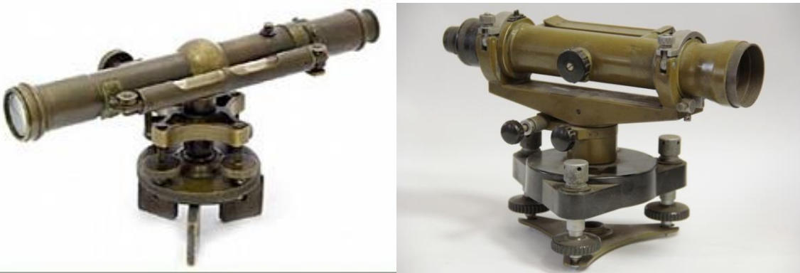
Slika 12. Klasični niveliri stare konstrukcije
