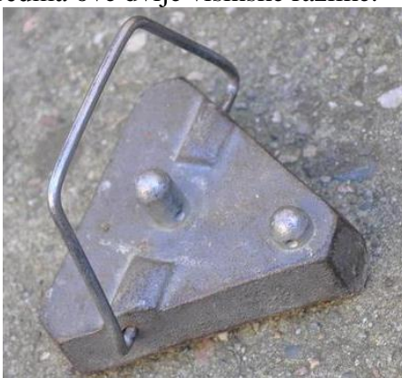
Slika 25. Nivelmanska papuča sa dva repera
